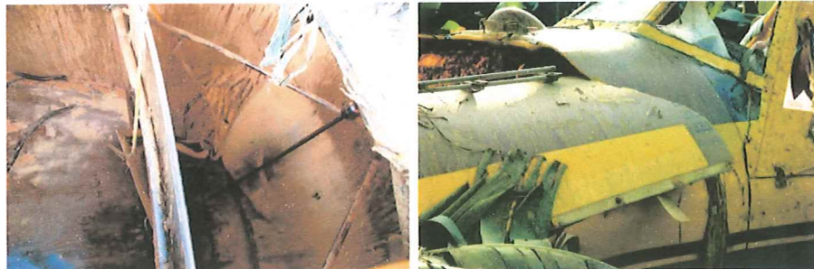
PERDIDA TOTAL DEL TANQUE DE INSECTICIDA.
