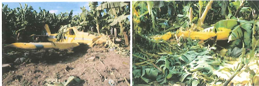
PERDIDA TOTAL DE LAS DOS ALAS POR DAÑO SEVERO EN LA ESTRUCTURA.
